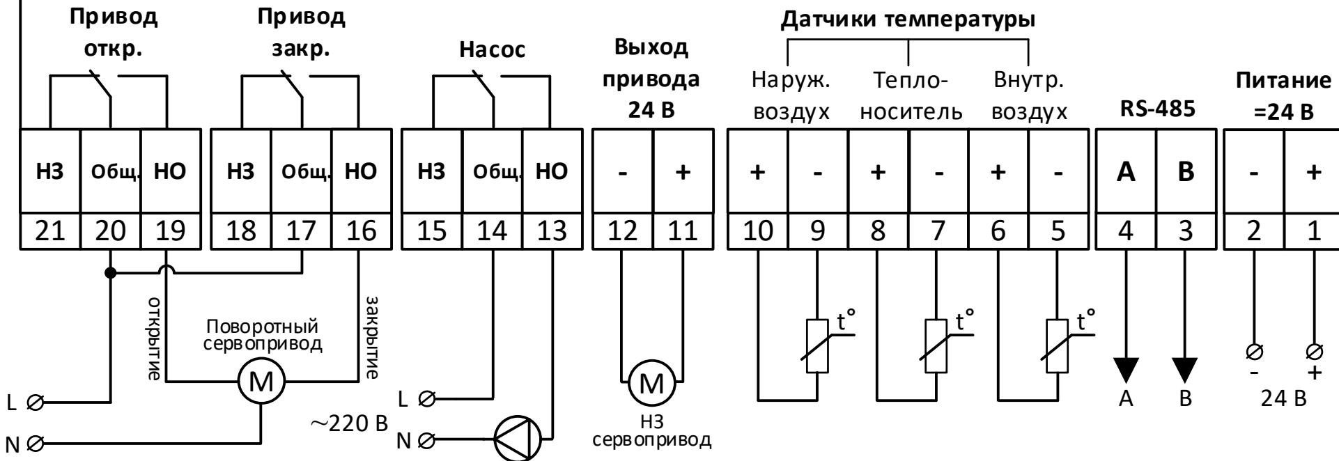
5.3.9 Подключение электротермического сервопривода производится напрямую к клеммам 11 и 12, при этом к контроллеру могут быть подключены как двухпозиционные электротермические сервоприводы с переменным, так и с постоянным напряжением питания. Максимальный ток выхода 200 мА. Исполнение сервопривода должно быть «нормально-закрытым». Рекомендуемые к использованию сервоприводы Valtec: [VT.TE3041.0.024](#), [VT.TE3043.0.024](#).
