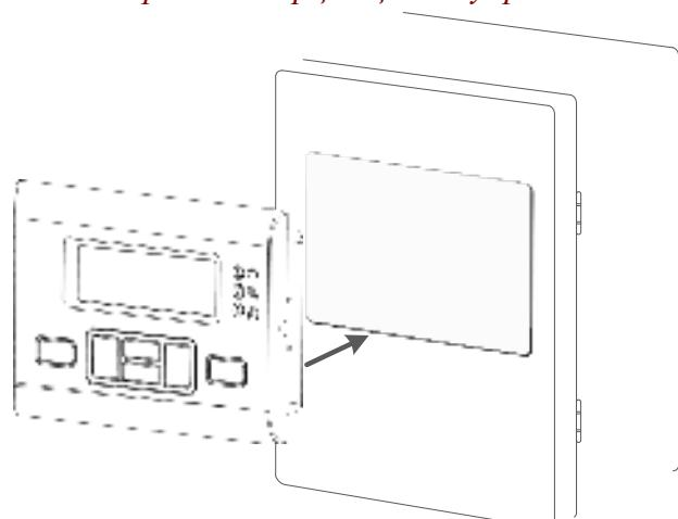
*Навесной монтаж осуществляется на плоскую поверхность на два винта в отверстия с тыльной стороны корпуса устройства*
